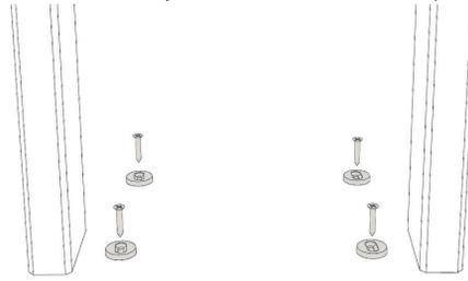
2. Fije los pies de aislamiento (A) a la parte inferior de la caja acústica con los tornillos proporcionados M10 x 25 mm (P).
